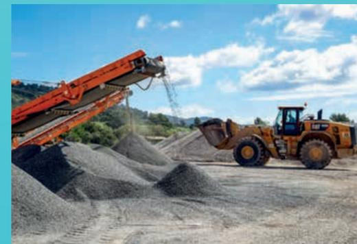
pavés en roche dure qui servent à stabiliser la structure des voies de chemins de fer. Ces éléments sont remplacés tous les 30 à 40 ans et sont habituellement envoyés en décharge. Après concassage, des essais en laboratoire ont été réalisés afin de vérifier que les granulats ainsi obtenus répondent aux normes autoroutières et ainsi éviter l'utilisation de ressources naturelles issues de carrière.
