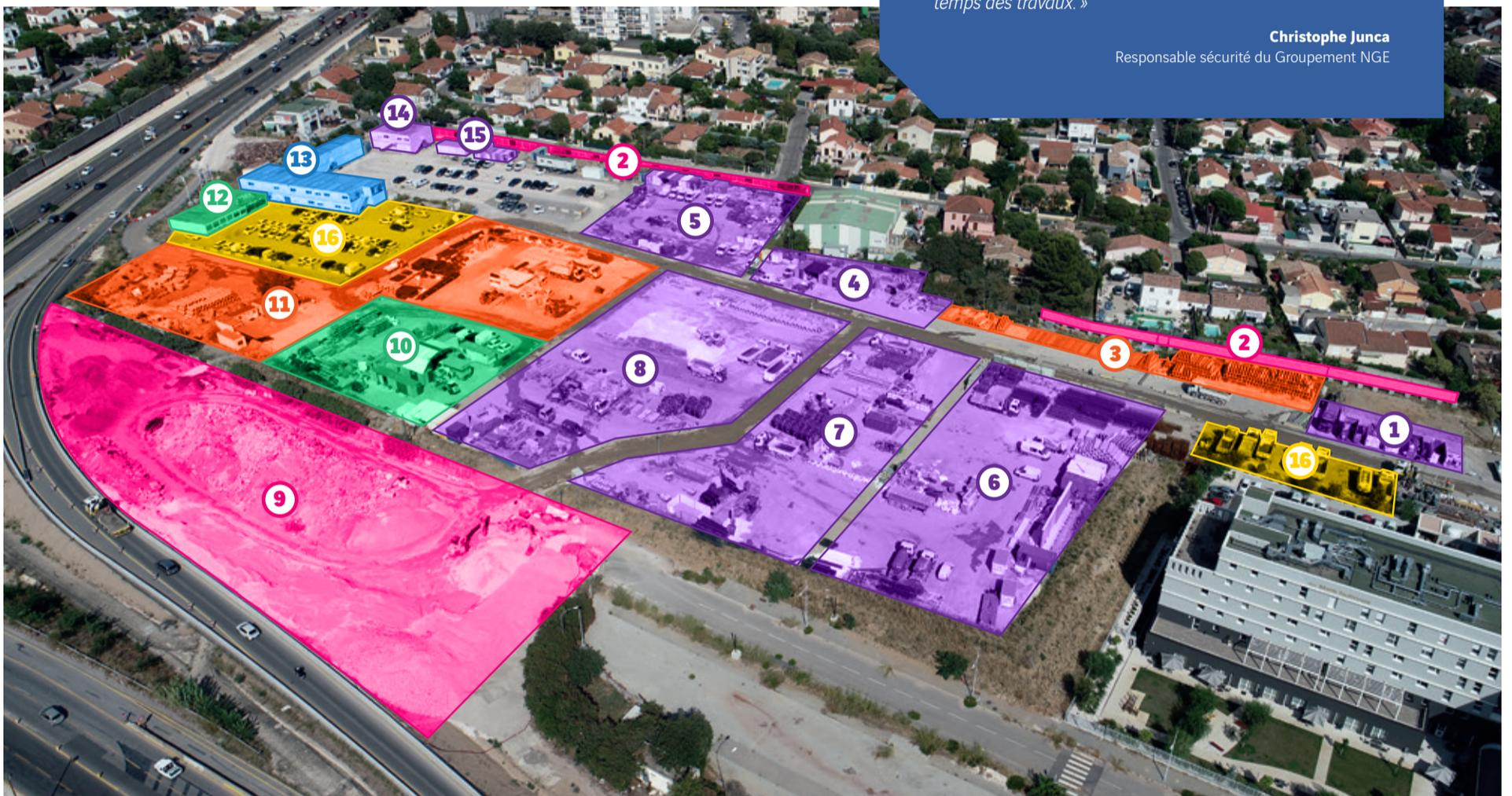
**Chaque métier intervenant dans le cadre des travaux (terrassement, assainissement, ouvrage d'art, chaussées, équipements, fondations et signalisation) dispose d'une zone de stockage de 2 500 m<sup>2</sup>. La base vie est sous vidéo-surveillance en permanence et dispose d'un gardiennage, nuit et jour, semaine et week-end.**
