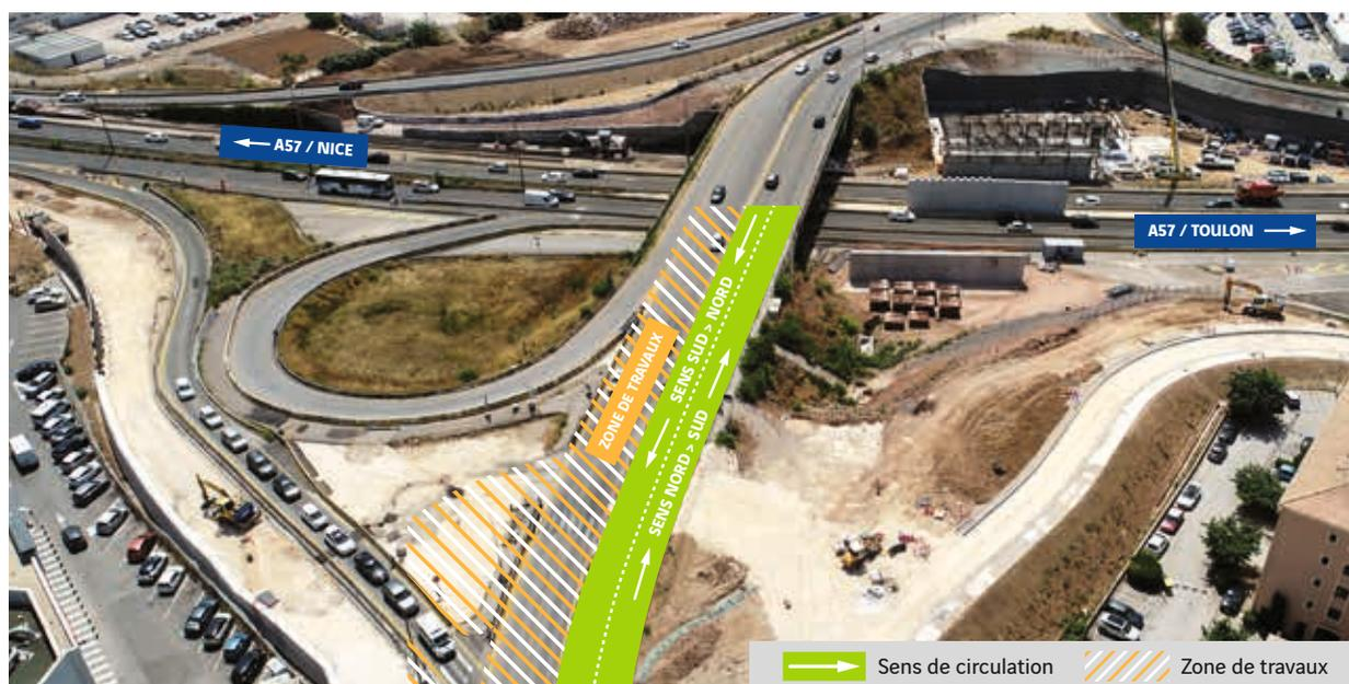
La deuxième phase de travaux verra la circulation, sur le pont enjambant l'A57, changer de côté. Ainsi, les conducteurs emprunteront la chaussée opposée, avec une seule voie dans chaque sens de circulation.
