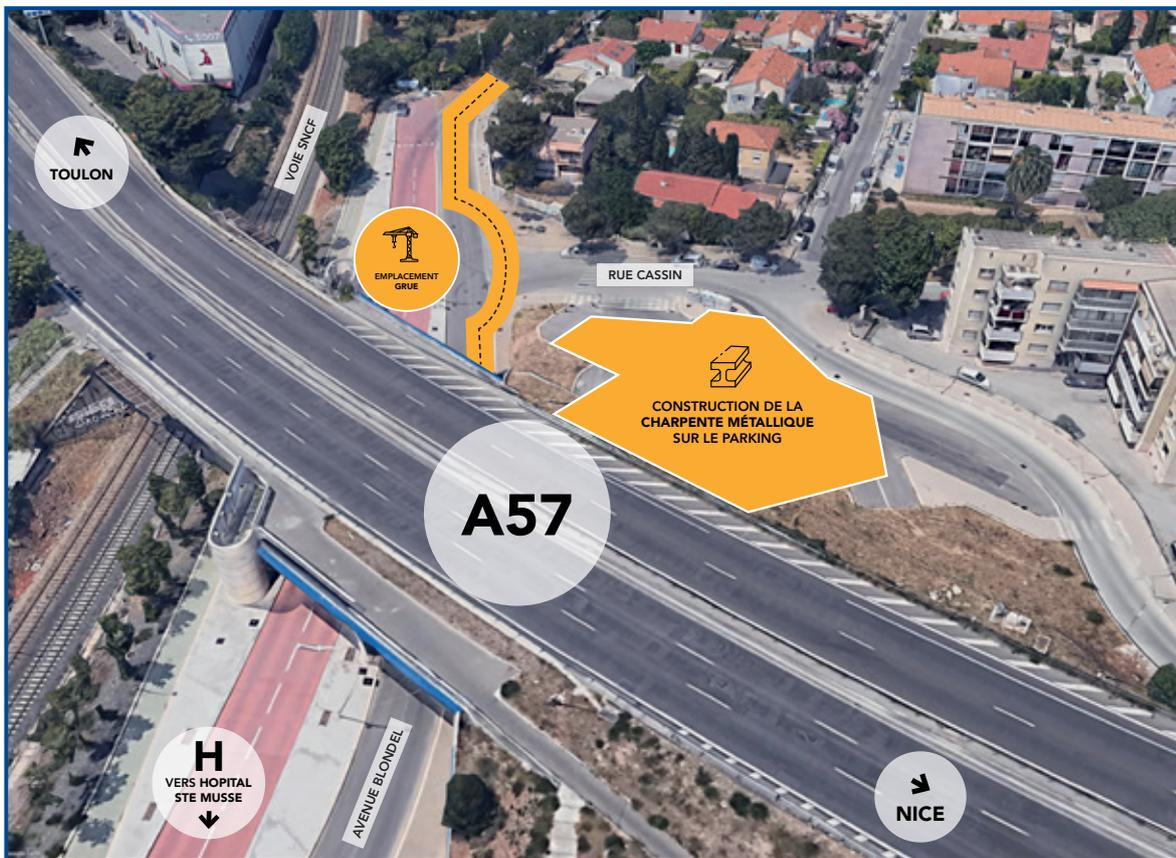
La largeur de la voirie de l'Avenue Blondel sera réduite afin de permettre l'installation, en bordure des voies ferrées, d'une grue. Cette dernière servira à lever et mettre en place les parties de la charpente métallique qui formera le pont provisoire. Ces opérations seront menées de nuit. En parallèle, les équipes continuent d'assembler la charpente métallique du futur pont.
